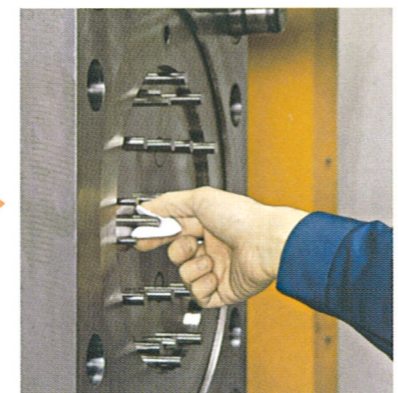
金型等の塗布面に、延ばすようにまんべんなく擦り込んでください。(白色から透明になるまで) 在模具等塗抹面上均匀地涂开,使其渗入。(直至从白色变为透明)
